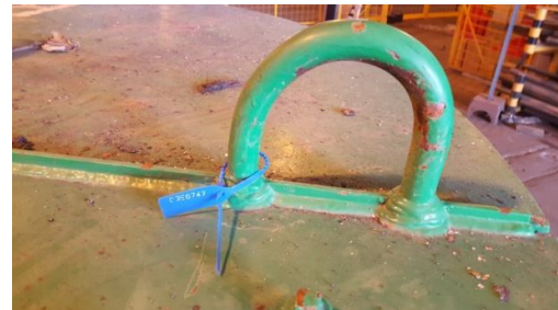
FIGURA 1: Precinto que indica aprobación en calderería.
