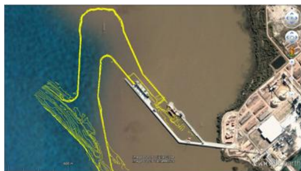
Figura 21 Relevamiento batimétrico (año 2016) de las áreas náuticas de la Terminal Portuaria
