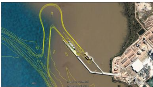
Figura 3. Relevamiento batimétrico (año 2014) de las áreas náuticas de la Terminal Portuaria
