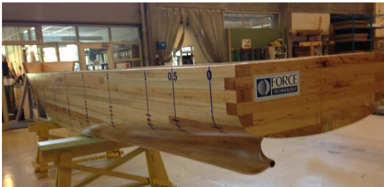
Fig. 3. Modelo físico a ser probado en el tanque de pruebas.
