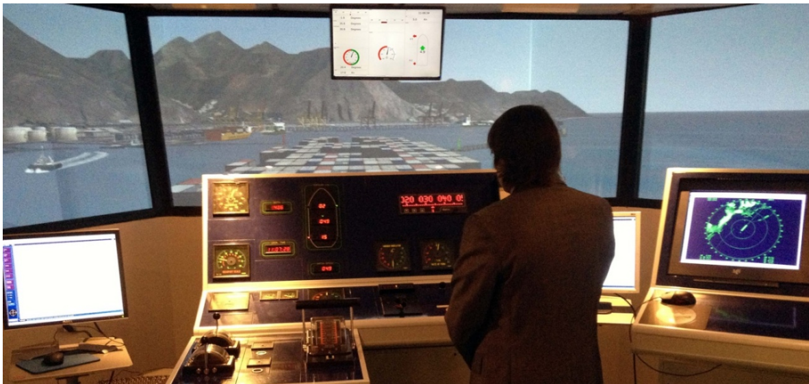
Figura 4. Simulador de maniobra en las instalaciones de Siport21
