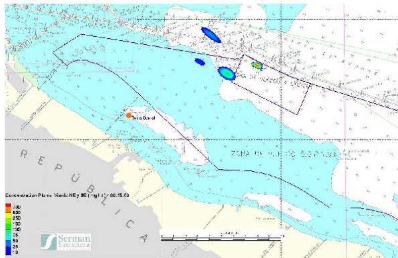
Figura 15 Concentración de sedimento en la pluma producida por descargas puntuales (cada 3,5 horas), de mezcla conservativa de limo fino y arcilla. Máximo avance de la pluma hacia el NO. Escenario con sudestada.
