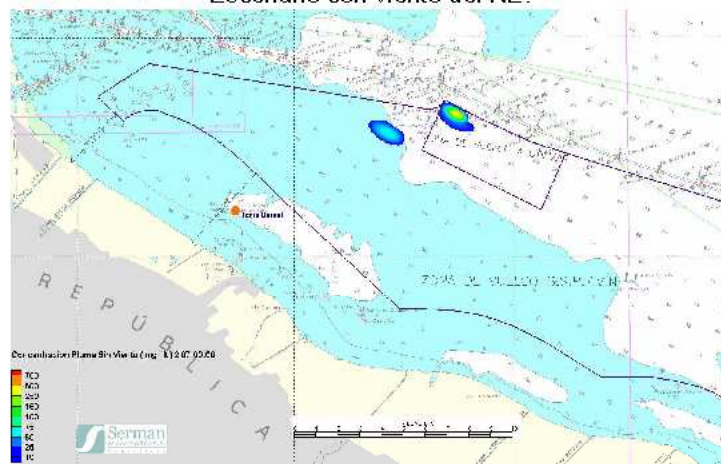
Figura 17 Concentración de sedimento en la pluma producida por descargas puntuales (cada 3,5 horas), de mezcla conservativa de limo fino y arcilla (25 km/h). Máximo avance hacia la costa. Escenario Sin
