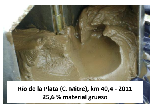
Figura 3. Muestras de sedimentos en la Vía Navegable Santa Fe – Océano.
