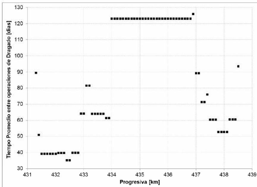
**Figura 6. Periodicidad media entre dragados de mantenimiento durante la temporada 2008-2009 en Paso Borghi.**
