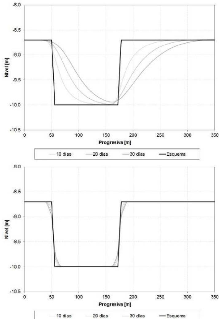
**Figura 11. Evolución de la sección transversal (subtramo N° 2) con a) efecto *Trampa* y b) efecto *Gravitatorio***
