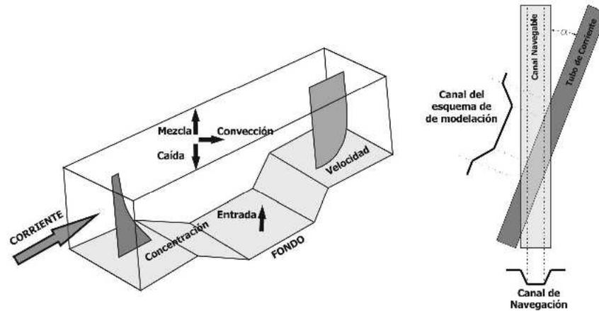
Figura 2.- Volumen de control para el modelo 2D-V.
