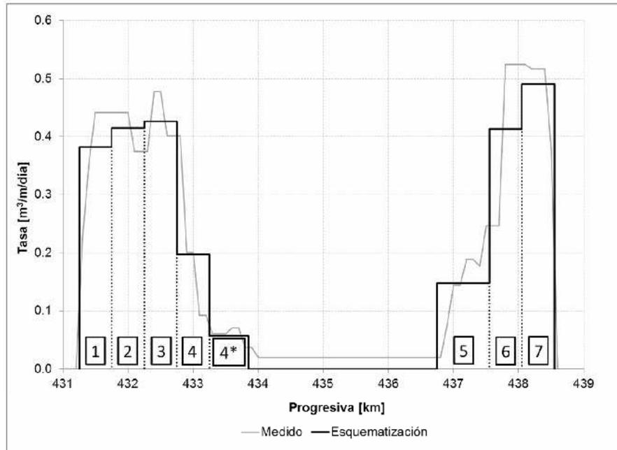
**Figura 5. Distribución longitudinal de tasa media anual de dragado de mantenimiento durante la temporada 2008-2009 en Paso Borghi.**
