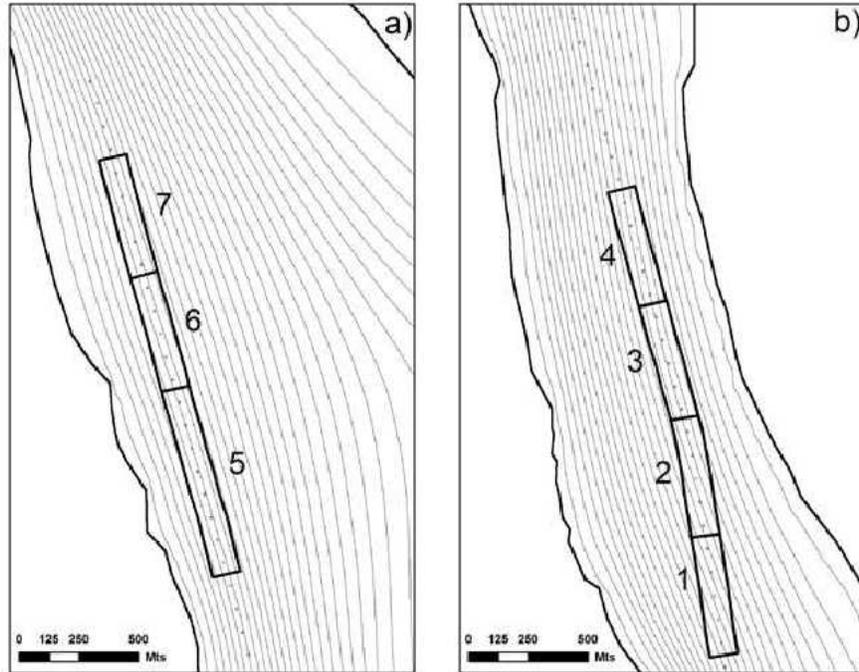
**Figura 9. Tubos de flujo para caudal medio en a) Borghi Superior y b) Borghi Inferior. Se grafican los tubos cada 500 m<sup>3</sup>/s.**
