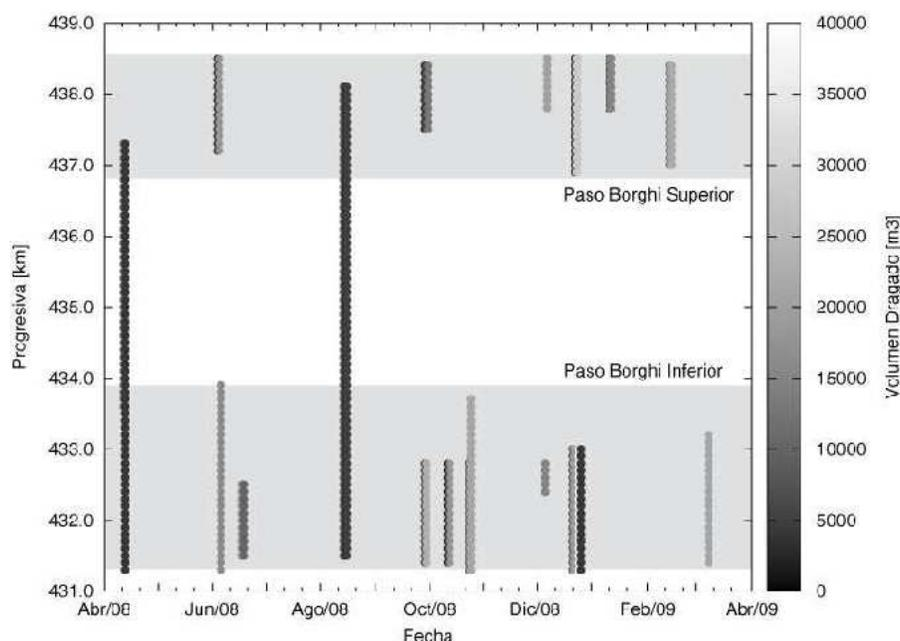
**Figura 4. Fecha, localización y volumen de dragado de mantenimiento en segmentos de 100 m de extensión durante la temporada 2008-2009 en Paso Borghi.**
