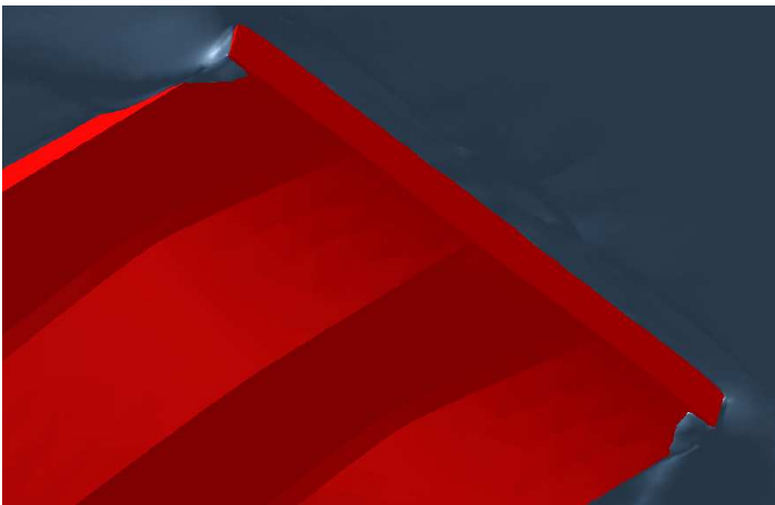
Figura 11: Aire atrapado en marcha atrás por defectos de la configuración del espejo
