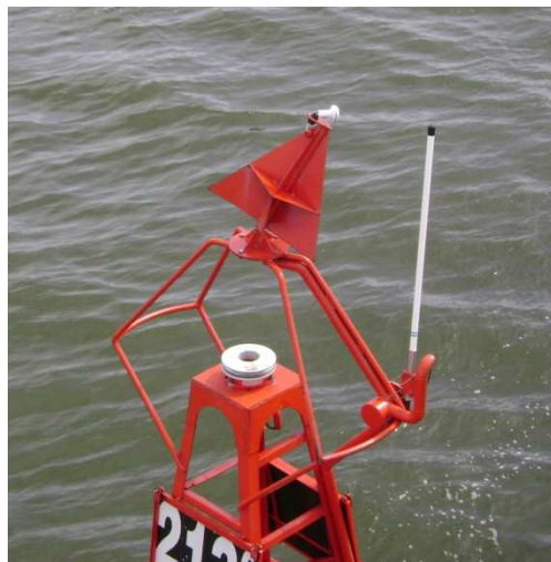
Figura 4: Antena GPS impactada
