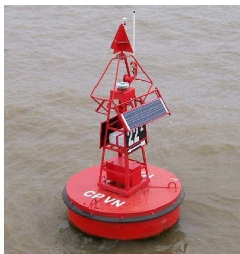
Figura 1: Señal II-B con AIS instalado
