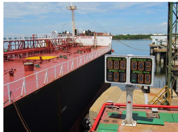
Figura 17. Las pantallas de matriz LED se pueden girar hacia el capitán durante el atraque.
