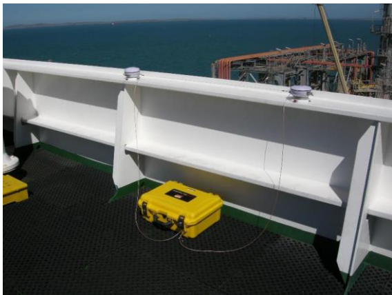
Figura 18. PPU de doble antena totalmente reforzadas utilizadas para la navegación y el atraque.
