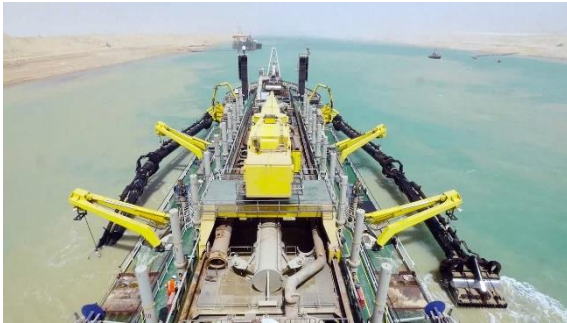
Figura 2: Dragas TSHD vista desde puente de mando durante elevación de tubos de succión luego de completar su cántara y previo a la navegación hacia sitio de descarga.
