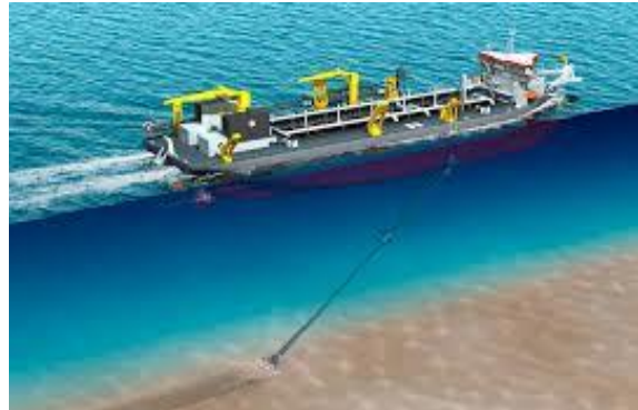
Figura 1: Esquema de Draga TSHD durante el proceso de dragado
